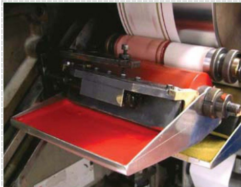
去除苯胺印刷机滚筒上的油墨
